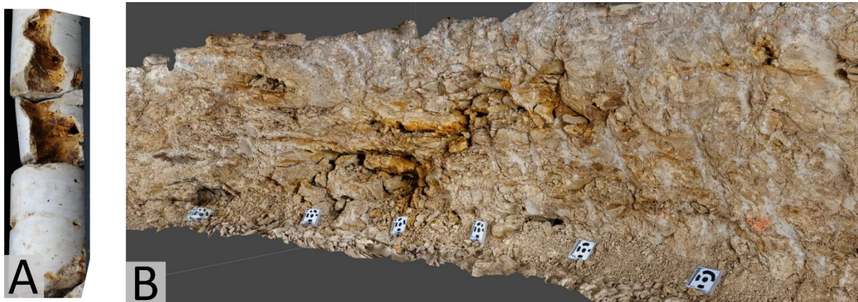
Figure 1 : illustration des échantillons physiques (A) : carotte dans un calcaire karstifié – et numérique (B) : modèle photogrammétrique d'un des niveaux de parois du puits.
