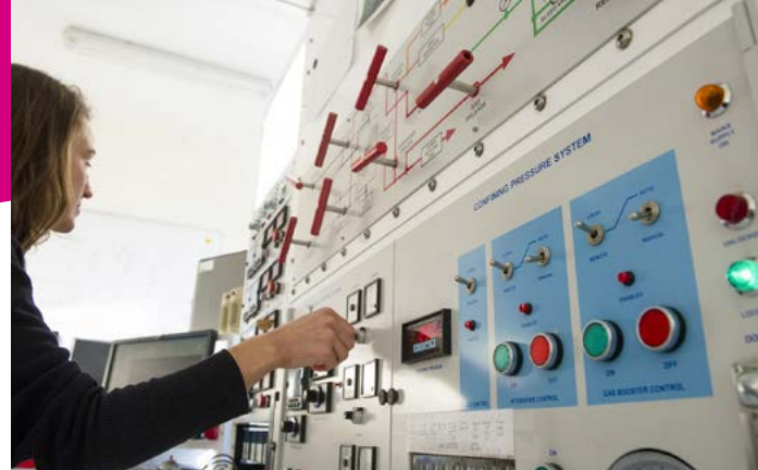
Presses Paterson pour HP/HT, expériences de déformation © ISTO
